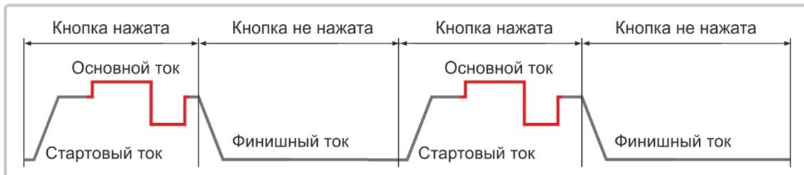
Для 4-тактного режима работы горелки повторяется следующий алгоритм:
